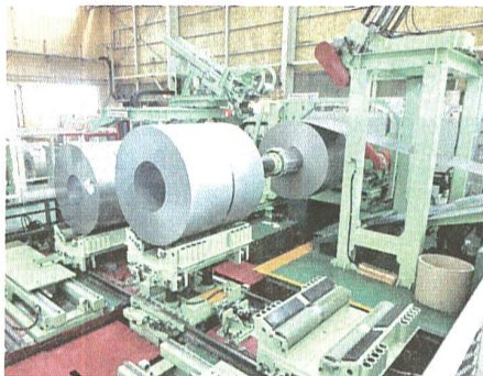
コイル台車を4台に増やし「入り側」を完全自動化に
