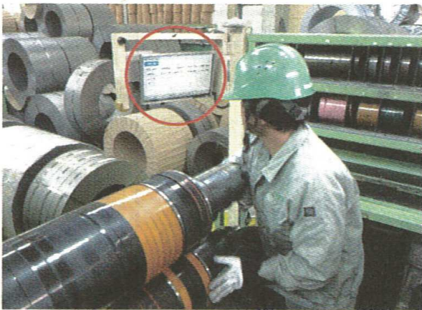
スリッター刃組みもモニタ画面(円内)で表示
