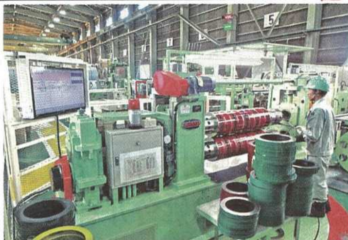
モニタ（写真左側）に表示された加工指示に従って刃組み
